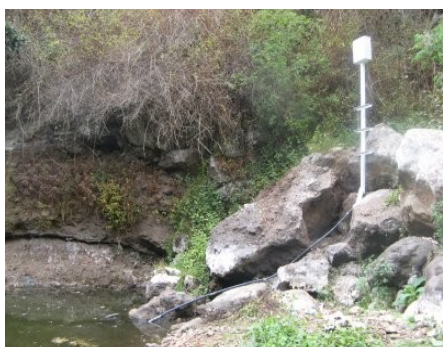
Station d'alerte de crues dans la ravine St Gilles
