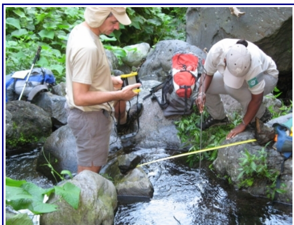
Jaugeage par le PNRun en gorges de la ravine des Orangers
